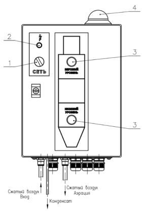
Рис.3. Панель управления щита монтажного
