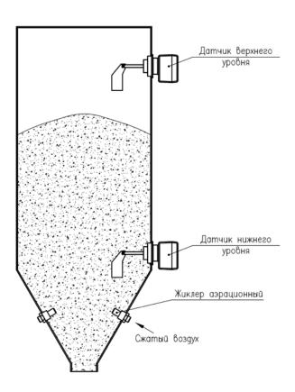
Рис.2 Расположение датчиков уровня цемента и системы аэрации
